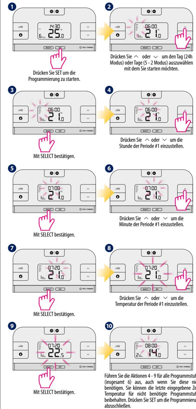
Führen Sie die Aktionen 4 - 9 für alle Programmstufen (insgesamt 6) aus, auch wenn Sie diese nicht benötigen. Sie können die letzte eingegebene Zeit/ Temperatur für nicht benötigte Programmstufen beibehalten. Drücken Sie SET um die Programmierung abzuschließen.
