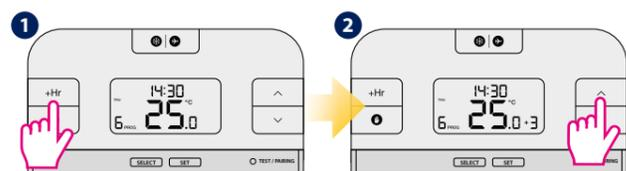
Drücken Sie +HR um die Anzahl der Stunden einzustellen (z.B. 3 Stunden, drücken Sie +HR 3 Mal).
