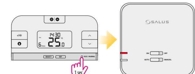
Um die Überprüfung zu beenden, drücken Sie kurz TEST / PAIRING.
