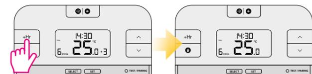
Drücken Sie so oft +HR bis die Stundenanzeige im Display verschwindet.
