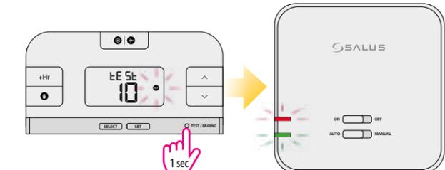
Drücken Sie kurz TEST/PAIRING zur Prüfung welche Sender / Empfänger miteinander verbunden sind. Die ROTE LED der verbundenen Empfänger fängt an zu blinken.
