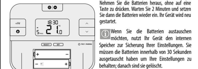
Nehmen Sie die Batterien heraus, ohne auf eine Taste zu drücken. Warten Sie 2 Minuten und setzen Sie dann die Batterien wieder ein. Ihr Gerät wird neu gestartet.
