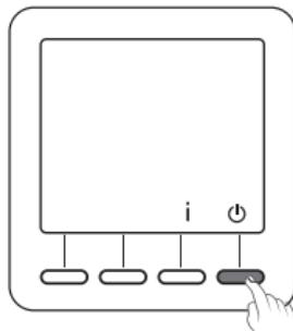
Dans ce mode, le chauffage est en arrêt.
