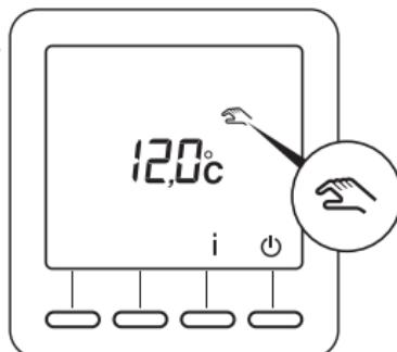
Sollte bei einer externen Programmunterbrechung das Symbol
