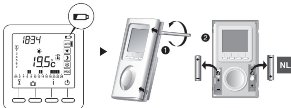
Vanaf het moment dat het symbool op het scherm wordt weergegeven, hebt u ongeveer 3 maanden de tijd om de batterijen te vervangen (zie technische kenmerken).
